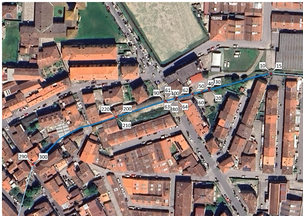
Figura 5.1. Planimetria della sezione del fosso Trescelle modellata e la posizione delle sezioni utilizzate nel modello HEC-RAS.
